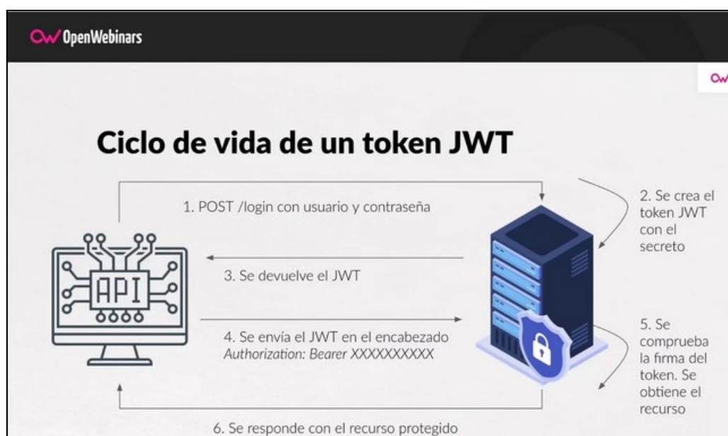
Fig. 4.32. Funcionamiento de un token JWT. [45]
