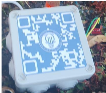
Ilustración 19. Fotografía de la carcasa del microcontrolador (se aprecia el código QR, el led en la parte superior y el sensor de agua clavado en la tierra).
